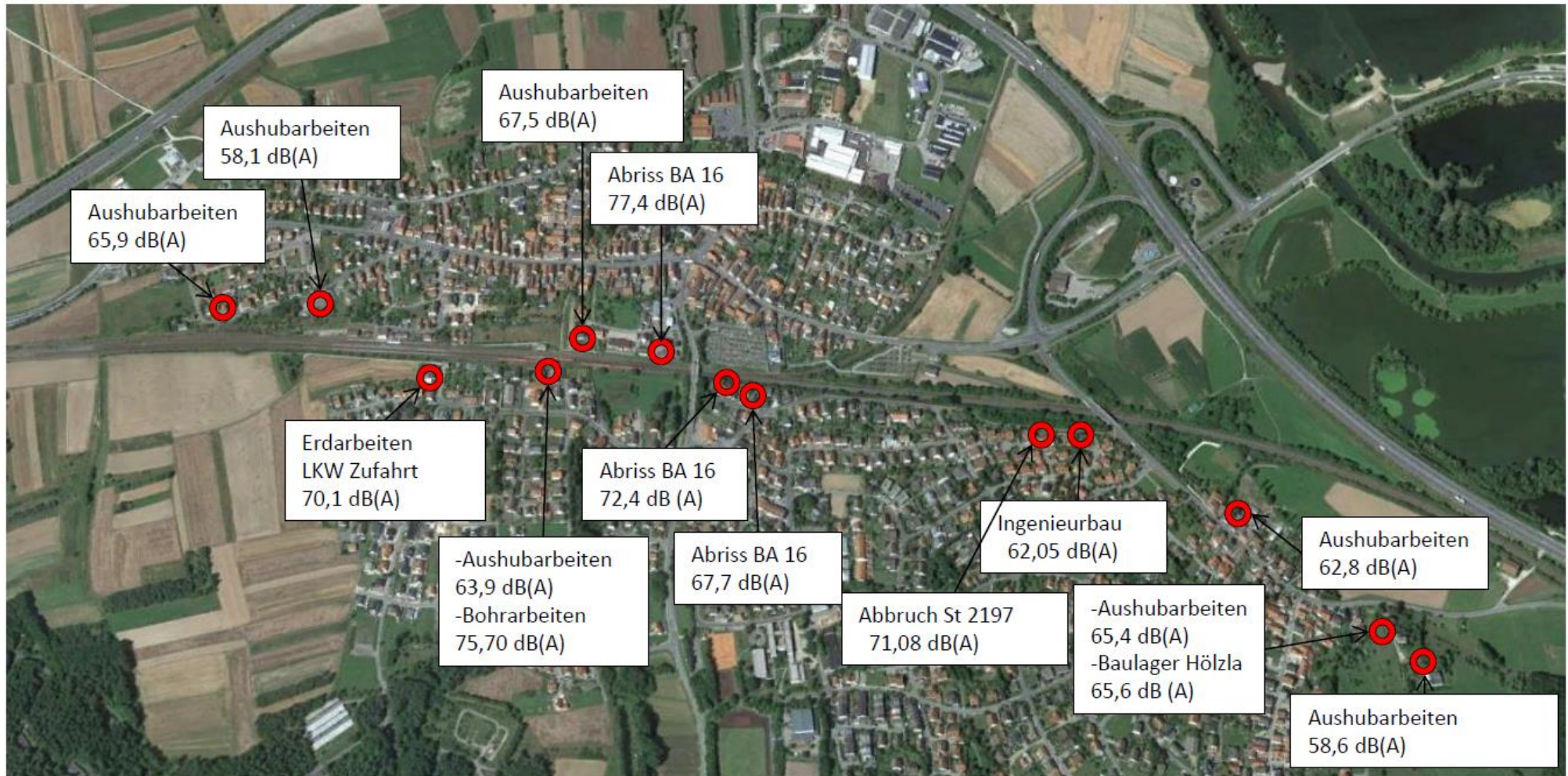
Darstellung der gemittelten Schallpegel während repräsentativen Bauarbeiten im Zeitraum 11.01.2016 bis 08.04.2016
