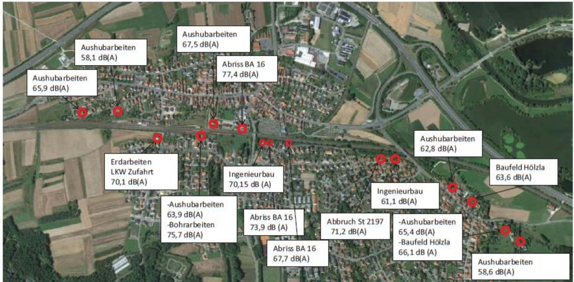
Darstellung der gemittelten Schallpegel während repräsentativen Bauarbeiten im Zeitraum 11.01.2016 bis 13.05.2016
