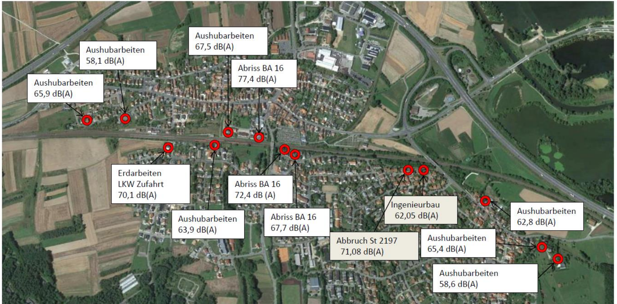
Darstellung der gemittelten Schallpegel während repräsentativen Bauarbeiten im Zeitraum 11.01.2016 bis 18.03.2016
